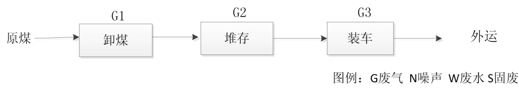
图 2 技改工程生产工艺流程图
