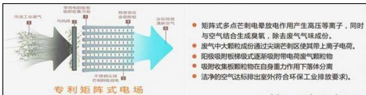
图 6.1-1 低温等离子净化有机废气处理原理图
