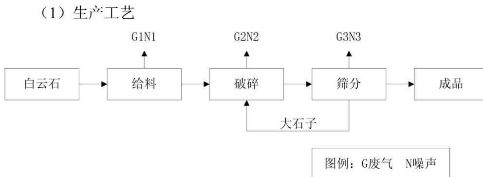
图2 生产工艺流程图
