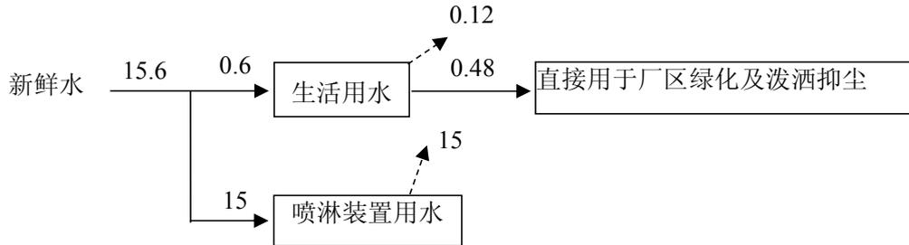
图 1 项目给排水平衡图 (m<sup>3</sup>/d)
