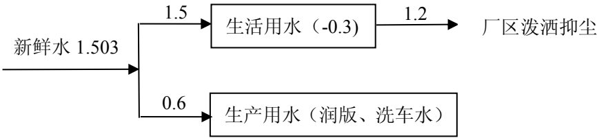
图 1 项目水量平衡图 (m 3 /d)
